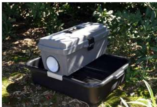
Figura 5: trappola Gravid assemblata e posizionata.
